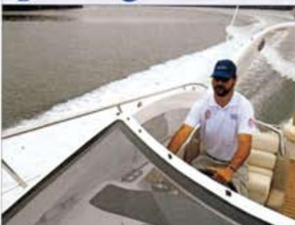
Tirando o comando mecânico que estava duro demais, a pilotagem foi um dos destaques: ágil e esperta, com curvas suaves e excepcional resposta na transposição de ondulações de proa. O ângulo V de 20° na popa pede mais motor, mas torna a navegação excelente.
