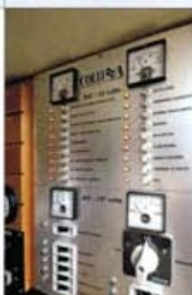
Fixação estanhada e codificada. Quadro elétrico completo e bem visível na entrada da cabine. Jogo de chaves de baterias de fácil acesso na escada de popa de boston. As quatro baterias ficam no porão, bem fixadas, acessíveis e bem protegidas da água.
